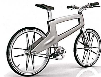
Jano by Roland Kaufmann An essentially shaped bicycle made from plywood, enabling the definition of a completely new geometry, with the lights and a stowage compartment incorporated in the structure itself. Made in collaboration with GP Designpartners, Vienna. L'utilizzo di compensato da modellismo (plywood) per la realizzazione di questa bicicletta dalle forme essenziali ha permesso la definizione di una geometria completamente nuova, che integra nella struttura le luci e il vano portaoggetti. Progetto realizzato in collaborazione con GP Designpartners, Vienna.
